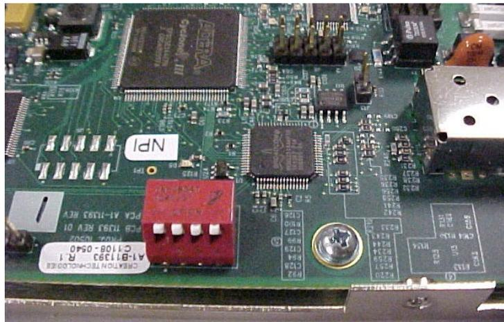
**Figure 15 : C6210 DIP Switches**
